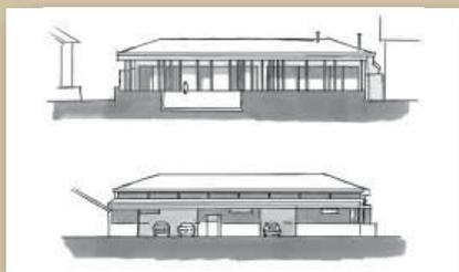
**PC5 - le plan de façades et des toitures :** il permet d'apprécier l'insertion du bâti sur le terrain, sa volumétrie, le rythme des percements, le choix des matériaux.
