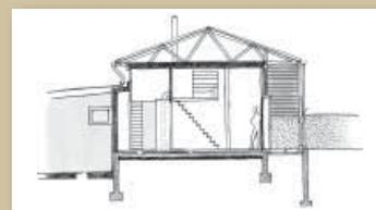
**PC3 - la coupe sur la construction et le terrain :** elle précise l'implantation de la construction par rapport au profil du terrain naturel et aux limites de parcelle. Elle permet d'exprimer le respect de la topographie, les mouvements de terrain...
