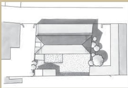
**PC2 - le plan masse :** il aide à comprendre l'implantation de la maison sur le terrain et les aménagements extérieurs. Ce plan doit faire apparaître l'orientation, l'échelle, les limites de la parcelle, les hauteurs du bâtiment, les reliefs, les écoulements d'eau, les raccordements, les voiries, les bâtiments à proximité, les plantations, les accès prévus...
